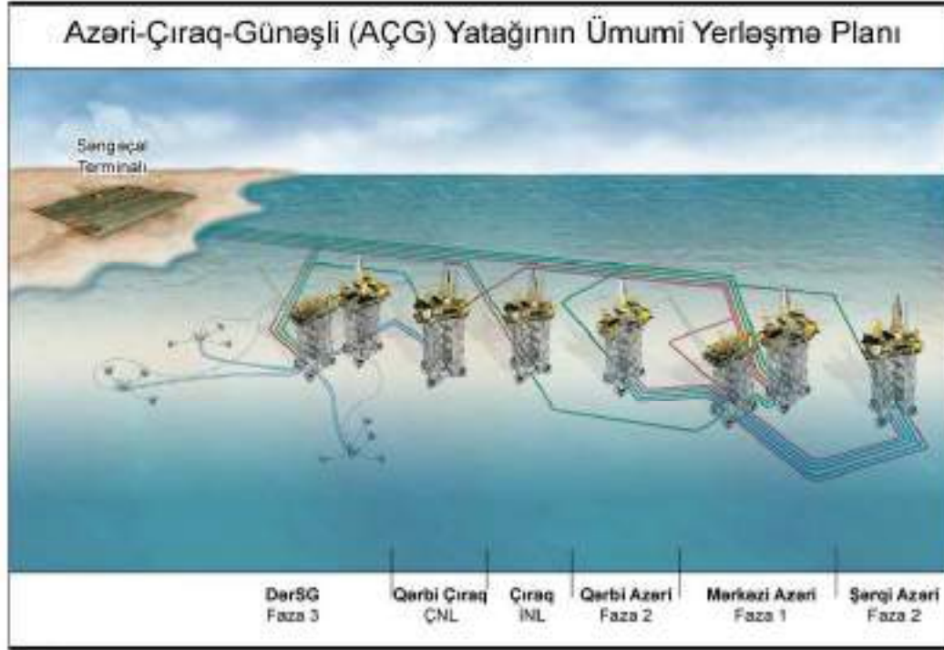
Şəkil E.2 AÇG Müqavilə Sahəsindəki dəniz qurğuları (ÇNL daxil olmaqla)
