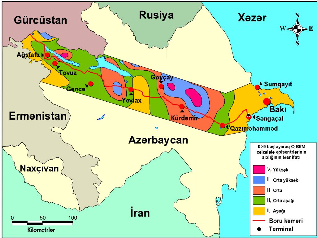
Şəkil 2. İBQKM əsasında BTC boru kəmərinin marşrutu boyu D > 9 zəlzələlərinin episentrələrinin sıxlığının təsnifatı
