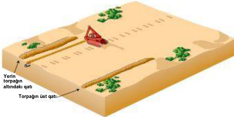
Şəkil 5-14 Xəndəyin örtülməsi işləri.
