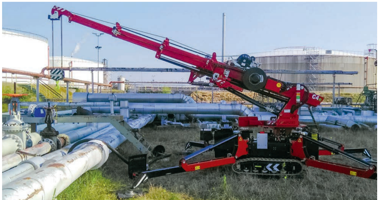
Der Minikran hebt selbst auf engstem Raum bis zu zwei Tonnen.
