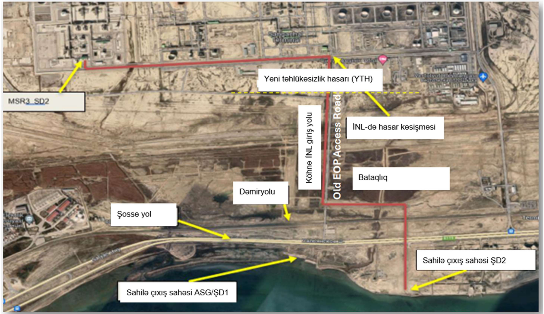
Şəkil 5.13: Səngəçal-ŞDK EFOK marşrutu üçün təklif edilmiş quru seksiyası ( Səngəçal Körfəzində sahilə çıxan sahədən yeni təhlükəsizlik hasarına qədər olan yeganə seksiya iş həcmi daxilindədir)
