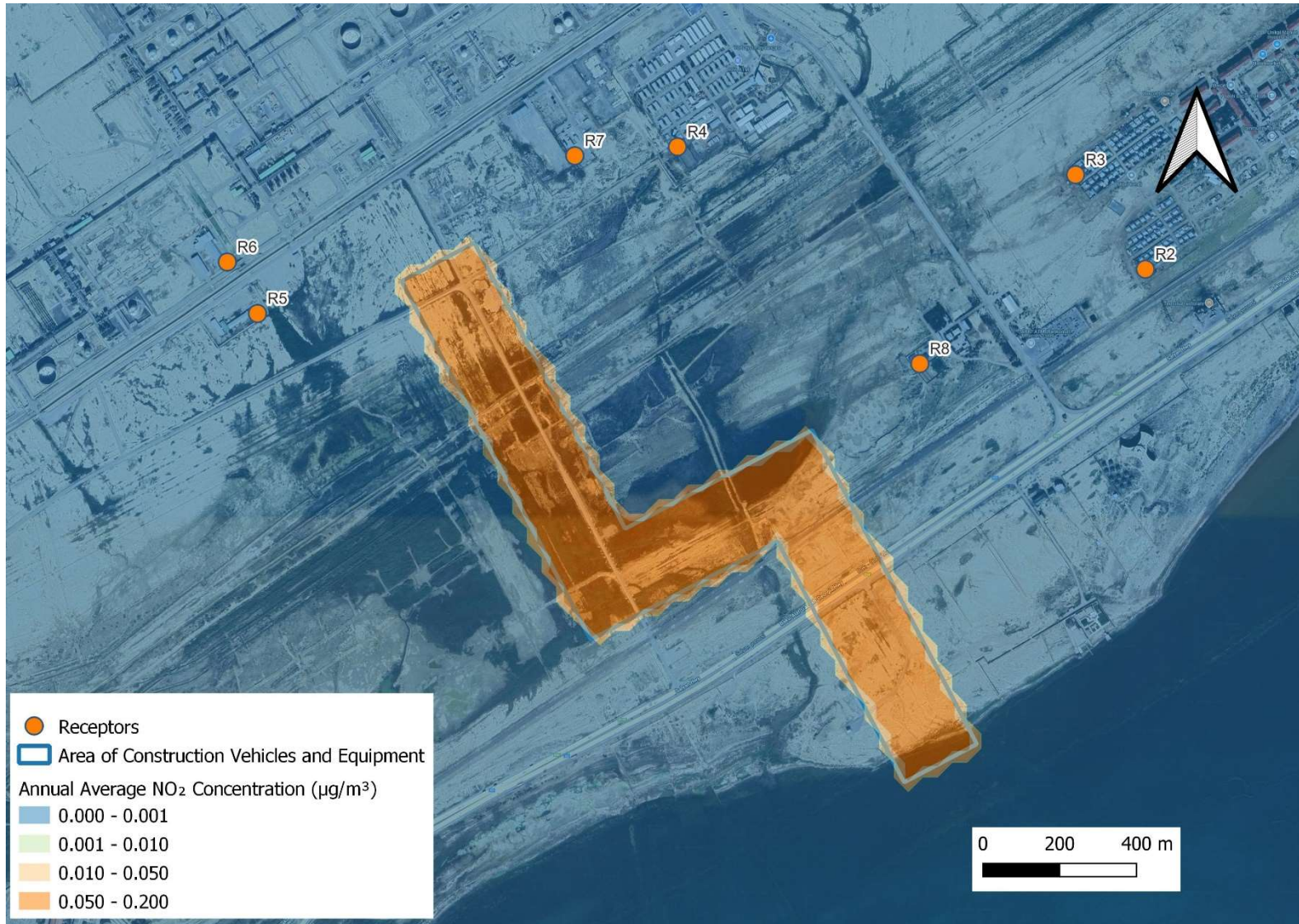
Şəkil D.5: İllik orta NO 2 konsentrasiyaları üzrə konturlu sxem – EFOK-in qurudakı marşrutu (2020-ci ilin meteoroloji məlumat toplusundan istifadə edilib)
