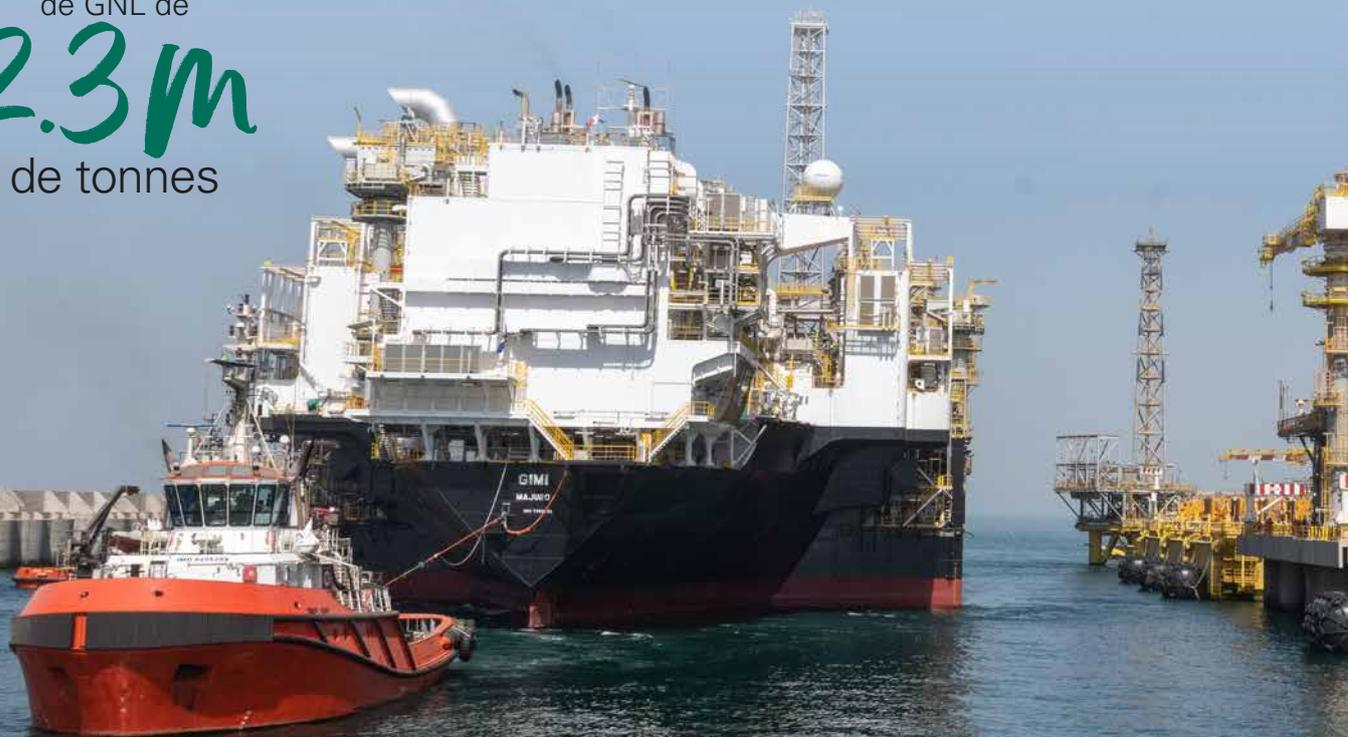
Cette étape a nécessité plus de 36 millions d'heures de construction et un voyage de plus de 9 000 milles nautiques jusqu'au site. Le projet produira du gaz à partir de réservoirs en eaux profondes situés à 120 km au large, le traitera sur le navire FPSO et l'acheminera vers le centre GTA pour le refroidissement cryogénique, le stockage et le transfert vers des méthaniers. Gimi peut contenir jusqu'à 125 000 m<sup>3</sup> de GNL.
